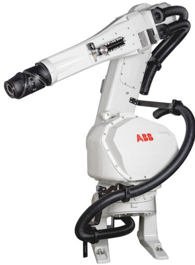
IRB 5510具有与IRB 5500相同的高级功能。相较于市场上同类型机器人，它外形小巧，占地空间小。作为一款多功能机器人，IRB 5510尤其适用于小型工件喷涂、火焰处理和开门应用等任务。
